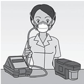
図4. N95マスク着用時の定量的フィットテスト
